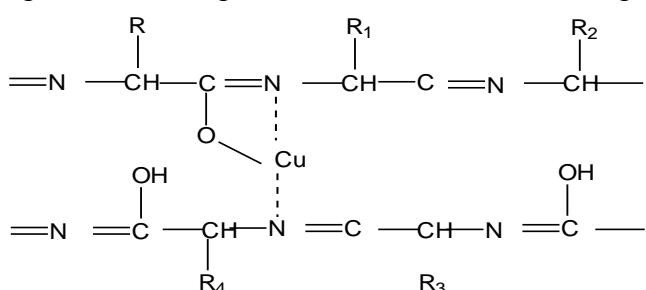
**Ход работы:** в пробирку налить 1 мл раствора белка, 1–2 мл 10%  $\text{NaOH}$  и 1–2 капли раствора сернокислой меди (1%). При взбалтывании появляется фиолетовое окрашивание.
